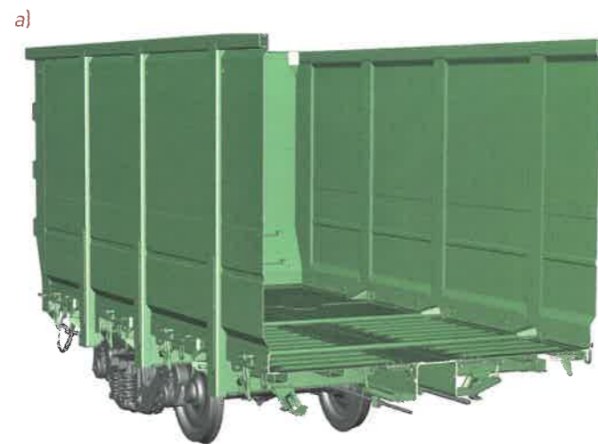
Рис. 7. Полувагон с выносом обшивки боковой стены: а – поперечный разрез, б – вид изнутри кузова
