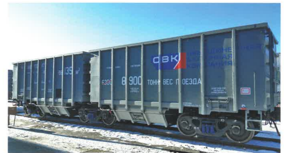
Рис. 10. Полувагон сочлененного типа модели 12-6877
