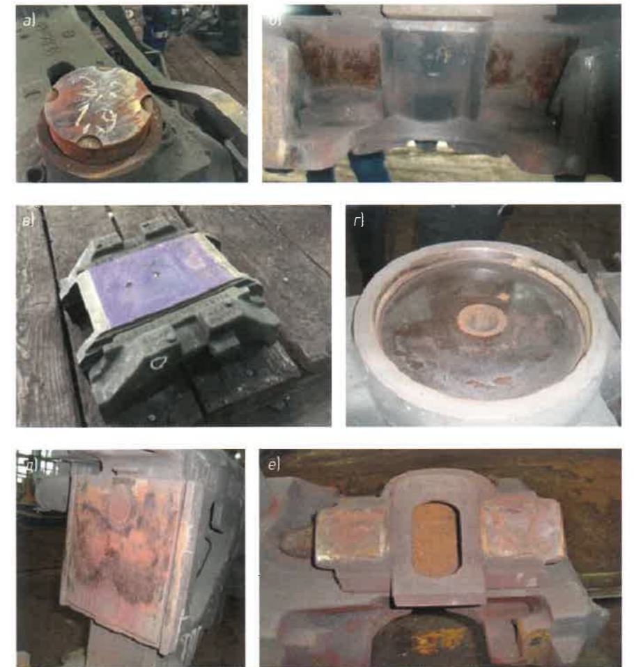
Рис. 3. Детали и поверхности тележки модели 18-9836, контролируемые при проведении подконтрольной эксплуатации: а – износостойкие опорная и упорная поверхности колпака и корпуса скользуна; б – рабочие наклонные поверхности кармана наддрессорной балки, поверхности упорных стенок кармана наддрессорной балки, поверхности вертикальных упоров наддрессорной балки; в – адаптер и упругая накладка; г – износостойкое кольцо подпятника, поверхность отверстия под шкворень; д – фрикционные планки в рессорном проеме; е – наклонные поверхности фрикционного клина, вертикальная поверхность фрикционного клина
