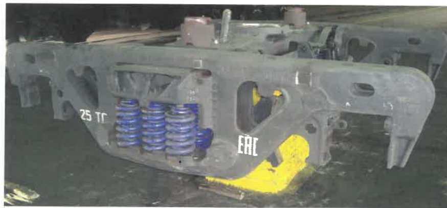
Рис. 4. Тележка на позиции разборки перед измерением контролируемых деталей
