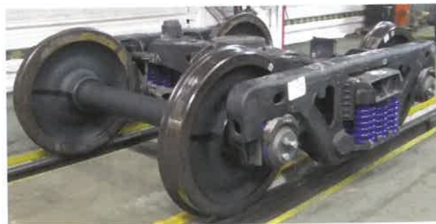
Рис. 1. Тележка модели 18-9836, изготовленная в соответствии с конструкторской документацией R AR-3441-02 [03]
