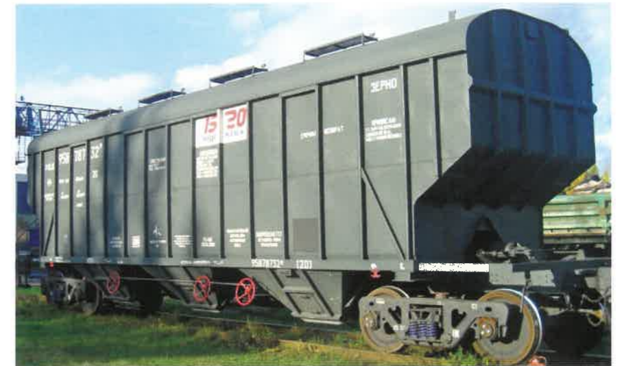
Рис. 2. Вагон-хоппер модели 19-9549-04 с тележками модели 18-9836
