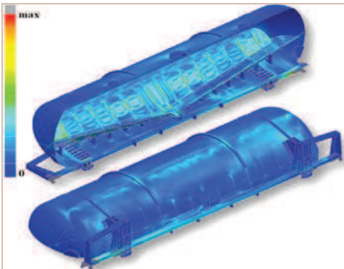
Рис. 6. Распределение эквивалентных напряжений по теории Губера-Мизеса при рывке по III расчетному режиму, МПа
