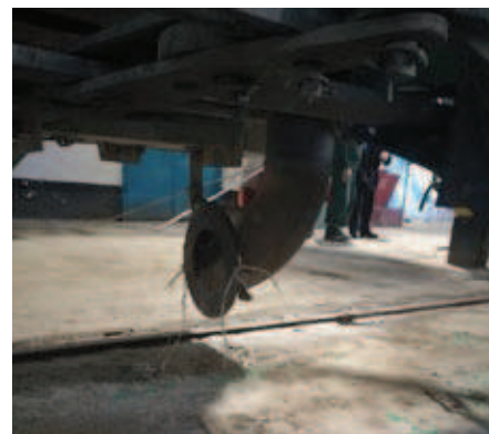
Рис. 2. Разгрузочный патрубок с одним фланцем
