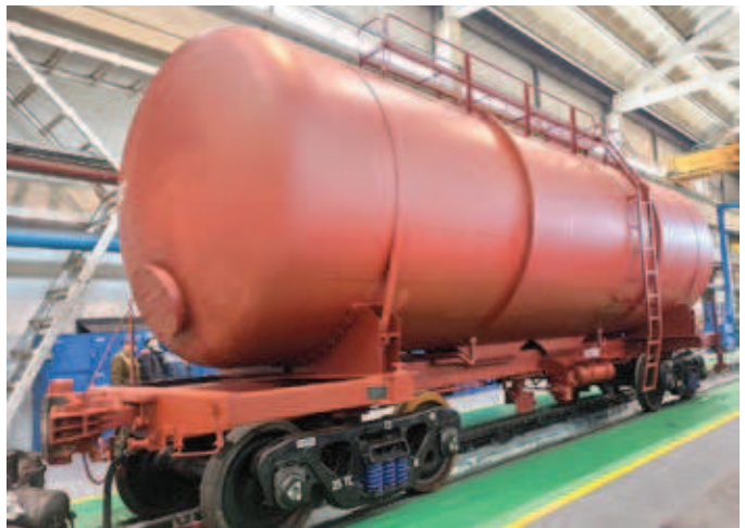
Рис. 7. Вагон-цистерна для цемента модели 15-627
